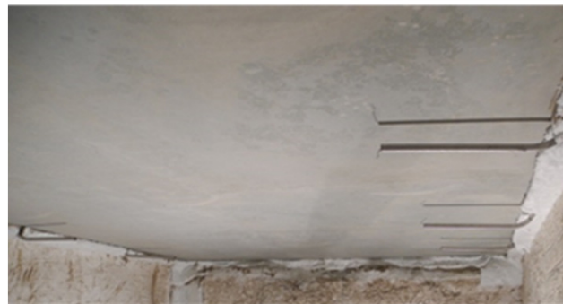
Figuur 1: afspatgevoelig beton. Links voor brandproef, rechts na brandproef
