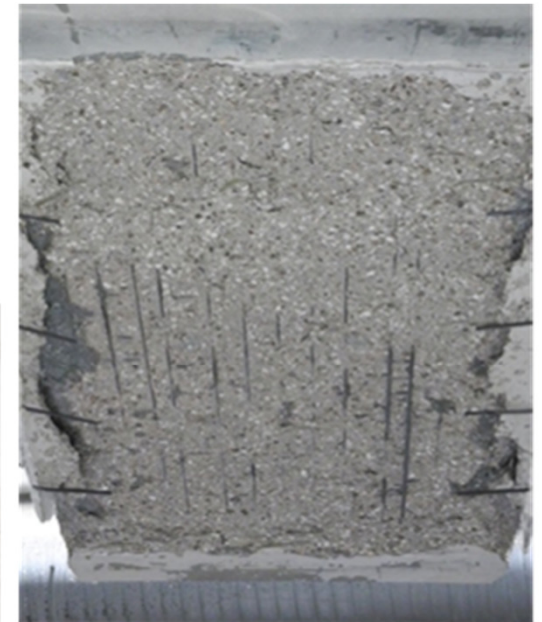
Figuur 1: afspatgevoelig beton. Links voor brandproef, rechts na brandproef
